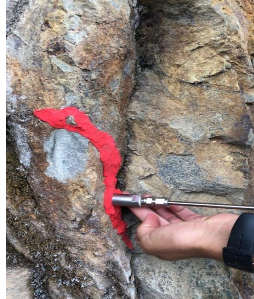
Imagen 6. Ensayo de la medición de la permeabilidad de una fractura empleando el PPP-250.
