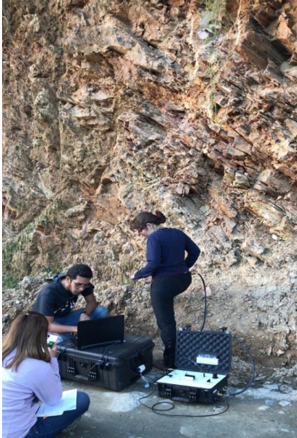
Imagen 5. Medición de la permeabilidad en un afloramiento de Complejo Quebradagrande empleando el PPP-250.
